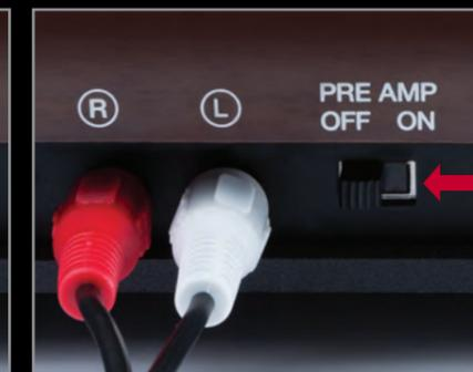
パワードスピーカーのようなプリアンプのない装置と接続する場合は、プリアンプスイッチをオンにしてください。PHONO 入力端子を持つ装置やプリアンプと接続する場合は、オフにしてください。
