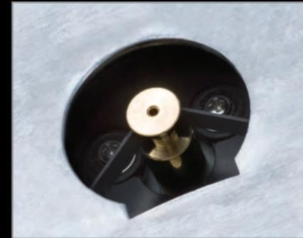
プラッターの裏側からベルトを引っ張り、ベルトをモーターの回転軸に引っ掛けながらプラッターを中心の軸に乗せます。
