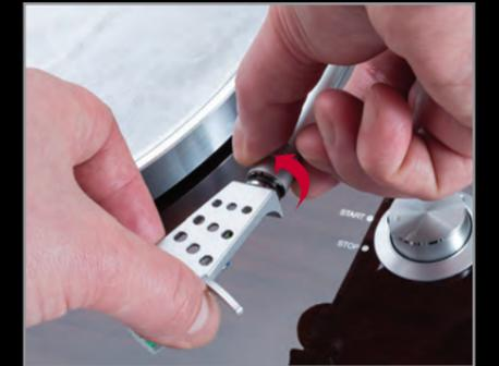
アームの首部分のねじを反時計回りに回してカートリッジを取り付けます。
