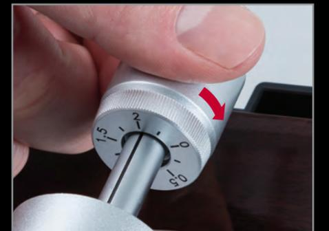
目盛りが手前になるようにして、カウンターウェイトをトーンアームに取り付け、目盛りを 0 に合わせて、トーンアームが水平になる位置まで、カウンターウェイトを前後へスライドさせます。その後、最適な針圧にするために目盛りを 2 に合わせます。
